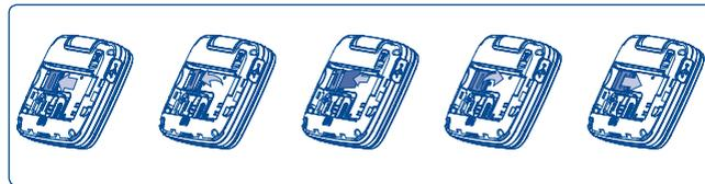
Pour dégager le support de la carte Micro-SD, faites-le glisser dans le sens de la flèche et soulevez-le. Insérez alors la carte Micro-SD, la face du contact doré vers le bas. Enfin, retournez le support de la Micro-SD et faites-le glisser dans le sens inverse pour le bloquer.
