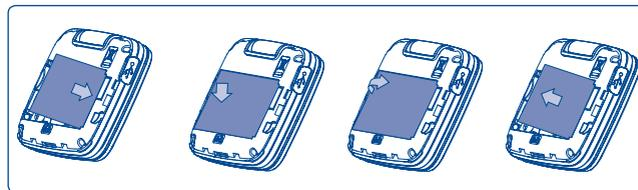
Engagez et clipsez la batterie puis insérez le couvercle arrière du téléphone. Déclipsez le couvercle arrière du téléphone puis retirez la batterie.
