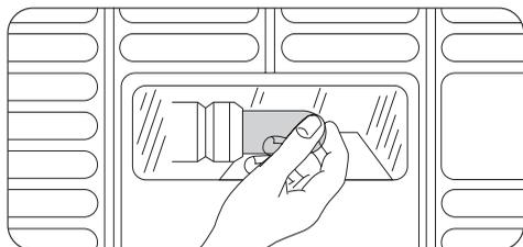
2. Remplacez l'ampoule par une ampoule de même puissance spécifiquement conçue pour les appareils ménagers (la puissance maximale est indiquée sur le diffuseur).
