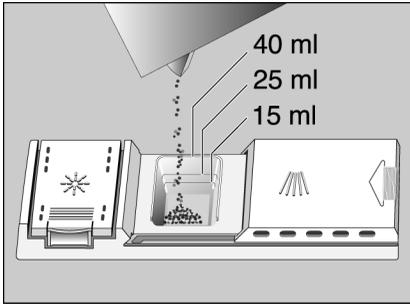
Si le compartiment à détergent [31] est encore fermé, actionnez le verrou d'obturation [29] pour l'ouvrir.
