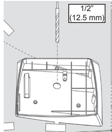
Drill Depth: 1.0" (25 mm) ♦ Profondeur de perçage : 25 mm (1,0 po)
