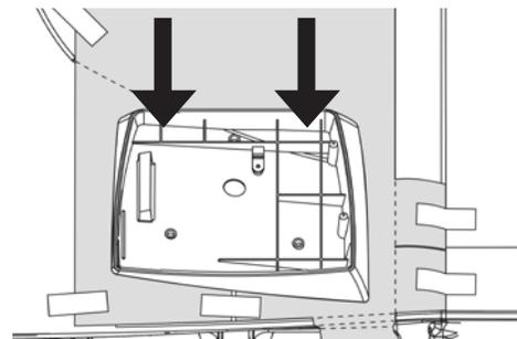
Place on dash. Press firmly 10 seconds. ♦ Placez-le sur le tableau de bord. Appuyez fermement pendant 10 secondes.
