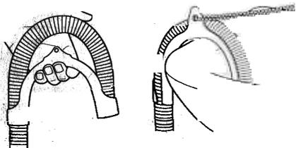
2. Suspendre le tuyau d'évacuation équipé de son support par-dessus le bord de l'évier ou de la baignoire et le fixer dans cette position pour l'empêcher de glisser – par exemple en l'enchaînant au robinet.
