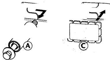
3. Poser les trois capuchons C (du sachet livré avec la machine) sur les ouvertures de la face arrière de l'appareil et les enfoncer à l'aide d'un outil (p. ex. un tournevis).
