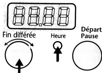
3. Tourner le bouton »Fin différée« jusqu'à ce que l'heure exacte soit affichée. L'afficheur s'arrête de clignoter.
