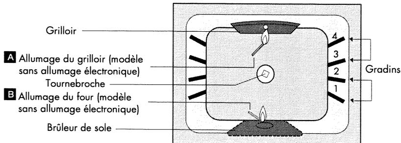
Les brûleurs de votre four gaz sont équipés d'un dispositif de sécurité (voir guide pratique). Une seule manette de thermostat contrôle le fonctionnement soit du four, soit du grilloir.
