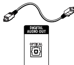
Prise et câble optique pour signal audio numérique.
