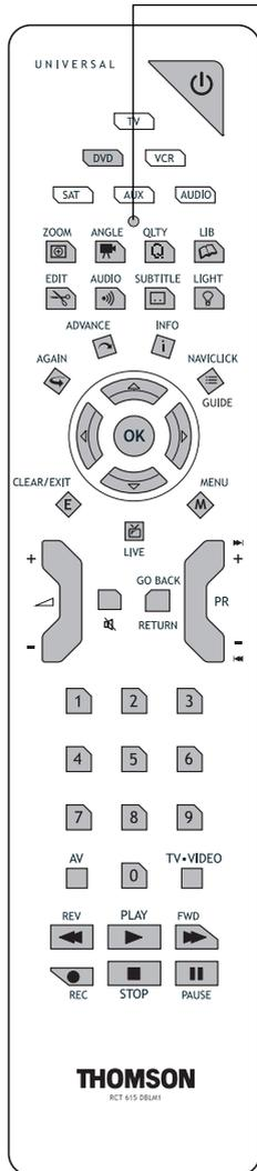
**Témoin lumineux** - Indique l'état de la télécommande lorsqu'elle est en cours de programmation pour commander un autre appareil. Indique aussi un niveau faible des piles en clignotant plusieurs fois lorsqu'on appuie sur une touche.
