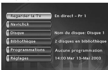
3. Sélectionnez la prise AV2 de l'enregistreur DVD avec la touche **AV** de la télécommande afin d'afficher **AV2-SAT-CABL** dans le bandeau et sur l'afficheur (*LIVE AV2*) de l'enregistreur DVD.
