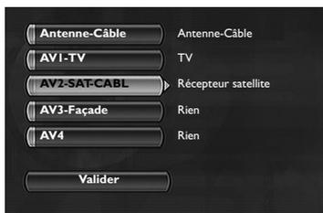
Note : **Récepteur du câble** ou **Récepteur satellite** : pour une connexion avec un récepteur satellite ou terminal câble sur la prise AV2 de votre enregistreur DVD (connexion de la page 8). Les autres réglages sont expliqués en page 6.
