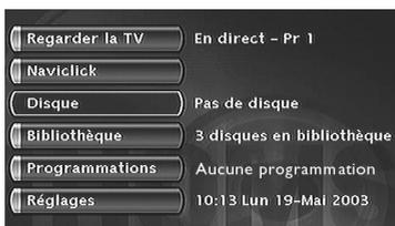
Note : la ligne **Disque** est inactive (transparente) s'il n'y a pas de disque ou si le disque est incompatible.
