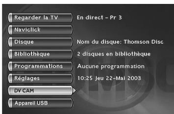
Note : La fonction **DV CAM** apparaît dans le menu lorsqu'un caméscope allumé (et en lecture de fichiers et de vidéos compatibles) est branché sur la prise **DV-IN**.
