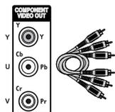
**Prises et câbles RCA pour signal Vidéo Y, Pb/Cb, Pr/Cr appelé également Composantes.**
