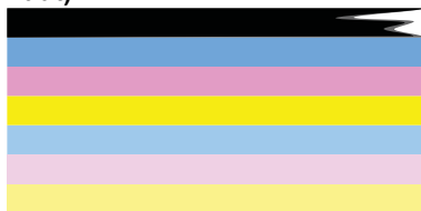
Figure 11-2 Barres de couleur : barre irrégulière ou teinte délavée (barre du haut)
