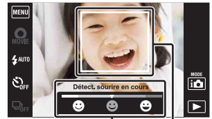
Indicateur de sensibilité de détection de sourire Cadre de détection de visage
