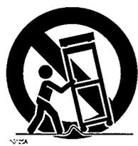
Si l'appareil est installé sur un chariot, déplacez-le avec précaution. Des arrêts brusques, une pression excessive et des surfaces inégales risquent de les renverser.
