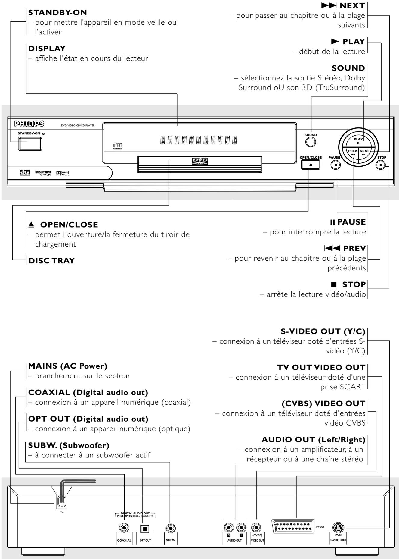
**Attention : Ne pas toucher les broches des prises situées sur le panneau arrière. Une décharge électrostatique peut provoquer un dommage irréversible à l'appareil.**
