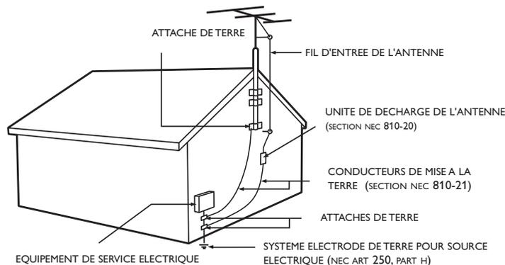
**Remarque pour les installateurs de système de câble:** Ce rappel s'adresse aux installateurs de système de câble afin d'attirer leur attention sur l'article 820-40 du code NEC qui indique la marche à suivre pour une mise à la terre adéquate et, en particulier, spécifie que le câble de masse doit être raccordé au système de mise à la terre du bâtiment, aussi près que possible du point d'entrée du câble.
