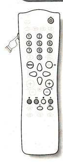
La touche VCR, située sur le coté de la télécommande, permet de piloter les fonctions principales du magnétoscope. Cette touche est disponible uniquement sur la télécommande représentée ci-contre.
