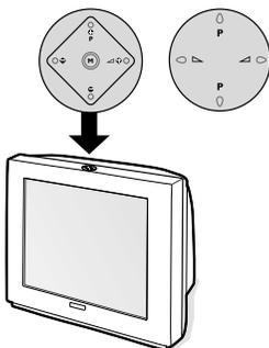
Selon les versions, le téléviseur est équipé de 4 ou 5 touches qui sont situées sur le dessus du coffret. Les touches **VOLUME** (-  $\triangle$  +) permettent de régler le volume. Les touches **PROGRAM** (- P +) permettent de sélectionner les programmes. La touche **M** (pour les versions à 5 touches), permet d'appeler, par appui successif, les réglages **Volume, Lumière, Couleur, Contraste, Aigus et Graves**.
