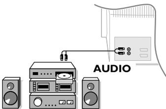
Pour le raccordement à une chaîne Hi-fi, utilisez un cordon de liaison audio et connectez les sorties "L" et "R" du téléviseur à une entrée "AUDIO IN" "L" et "R" de la chaîne Hi-fi.
