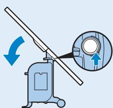
**5** Drücken Sie die Bügelbrett-Kipptaste, und bringen Sie das Bügelbrett in waagerechte Position.
