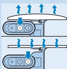
**10** Wenn Sie die Aufblas- oder Saugfunktion des Bügelbretts verwenden möchten, drücken Sie entweder die Aufblas- oder die Saugtaste auf dem Bügeleisen.
