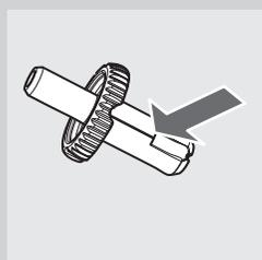
**20** S'assurez d'avoir enlevé tous les résidus de lait sur la cannelure du raccord (voir la flèche dans la figure à gauche). Dans le cas contraire, il ne sera pas possible d'émulsionner le lait. Bien nettoyer avec un chiffon humide abrasif.
