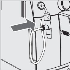
**7** Mettre le pivot avec le tuyau d'aspiration dans le Cappuccinatore.
