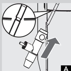
**22** Insérez le Cappuccinatore jusqu'à entendre l'enclenchement dans le logement, indiqué dans la Fig.1, présent dans la buse de vapeur.
