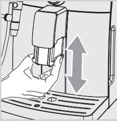
Pour effectuer ce réglage, soulever ou baisser la buse de distribution du café manuellement, en plaçant les doigts comme le montre la figure.
