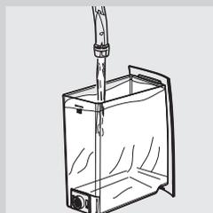
**4** Extraire le réservoir à eau et y verser tout le contenu du détartrant Saeco. Remplir le réservoir avec de l'eau fraîche jusqu'au niveau MAX.
