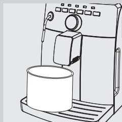
**6** Placer un récipient suffisamment grand (1,5 l) sous la buse de vapeur/ eau chaude et sous la buse de distribution.
