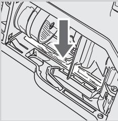
**1** Appliquer la graisse uniformément sur les deux convoyeurs latéraux.
