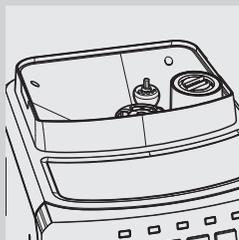
Nettoyer le réservoir à café en grain une fois par mois quand il est vide avec un chiffon humide afin d'éliminer les substances huileuses du café. Le remplir à nouveau avec le café en grains.
