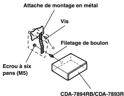
Si votre véhicule possède une applique, installez le long boulon à tête hexagonale sur le panneau arrière du CDA-7894RB/CDA-7893R et placez le bouchon caoutchouté sur le boulon à tête hexagonale. Si le véhicule ne possède pas de support de montage, renforcez l'appareil principal avec une bande de montage métallique (non fournie). Raccordez tous les fils du CDA-7894RB/CDA-7893R de la manière décrite dans la section "RACCORDEMENTS".
