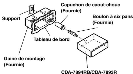
Enlevez l'attache de montage de l'appareil (voir "Dépose" à cette page).
