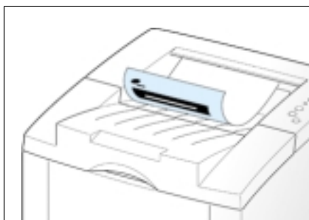
▲ Bac de sortie supérieur
