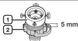
3. Raccordez l'adaptateur au robinet en serrant fermement les vis. Tournez la partie (2) dans le sens de la flèche, puis raccordez (1) et (2).
