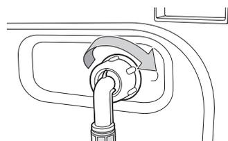
6. Ouvrez l'arrivée d'eau et vérifiez l'absence de fuite d'eau au niveau de la soupape d'admission d'eau, du robinet ou de l'adaptateur. En cas de fuite d'eau, répétez les étapes précédentes.
