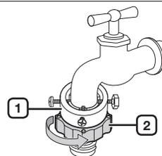
4. Raccordez le tuyau d'arrivée d'eau à l'adaptateur. Lorsque vous lâchez la partie (3), le tuyau se raccorde automatiquement à l'adaptateur en faisant un « clic ».
