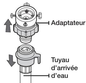
2. Tout d'abord, à l'aide d'un tournevis cruciforme, desserrez les quatre vis de l'adaptateur. Prenez ensuite l'adaptateur et tournez la partie (2) dans le sens de la flèche, jusqu'à obtenir un écart de 5 mm.
