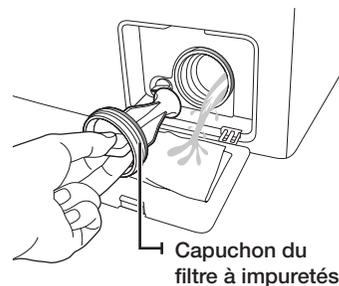
4. Nettoyez toute impureté ou autre matériau présent dans le filtre. Assurez-vous que l'hélice de la pompe de vidange, située derrière le filtre à impuretés, n'est pas bloquée.
