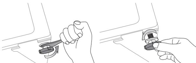
3. Lorsque le lave-linge est de niveau, serrez les écrous à l'aide de la clé fournie.
