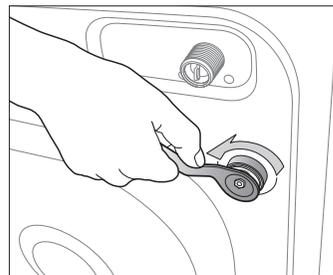
2. Maintenez la vis avec la clé et faites-la passer dans la partie large du trou. Répétez l'opération pour chaque vis.
