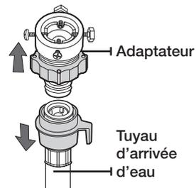
2. À l'aide d'un tournevis cruciforme, commencez par desserrer les quatre vis de l'adaptateur. Prenez ensuite l'adaptateur et tournez la partie (2) dans le sens de la flèche, jusqu'à obtenir un écart de 5 mm.
