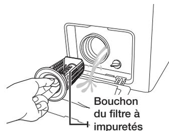
4. Retirez toute impureté et autre corps étranger pris dans le filtre et nettoyez ce dernier. Assurez-vous que l'hélice de la pompe de vidange située derrière le filtre n'est pas bloquée.
