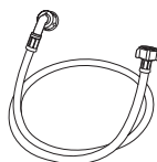
Tuyau d'arrivée d'eau
