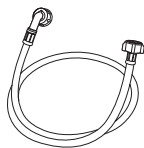
Tuyau d'arrivée d'eau
