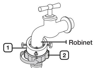
4. Raccordez le tuyau d'arrivée d'eau à l'adaptateur. Lorsque vous lâchez la partie (3), le tuyau se raccorde automatiquement à l'adaptateur en émettant un petit clic d'enclenchement.
