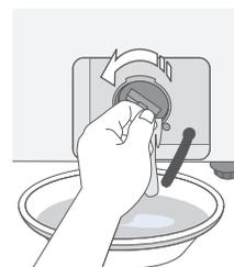
5. Retirez toute impureté et autre corps étranger pris dans le filtre et nettoyez ce dernier. Assurez-vous que l'hélice de la pompe de vidange située derrière le filtre n'est pas bloquée.
