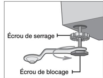
3. Une fois votre lave-linge stabilisé, serrez l'écrou de serrage à l'aide d'un tournevis plat.
