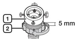
3. Raccordez l'adaptateur au robinet en serrant fermement les vis et en levant l'adaptateur vers le haut. Tournez la partie (2) dans le sens de la flèche pour la fixer à la partie (1).
