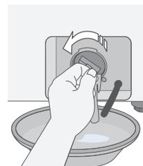
5. Nettoyez toute impureté ou autre matériau présent dans le filtre. Assurez-vous que l'hélice de la pompe de vidange, située derrière le filtre à impuretés, n'est pas bloquée.
