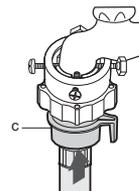
5. Raccordez l'autre extrémité du tuyau d'arrivée d'eau à la soupape d'admission d'eau, à l'arrière du lave-linge. Vissez le tuyau à fond dans le sens des aiguilles d'une montre.
