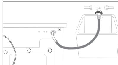
2. Raccordez l'autre extrémité du tuyau d'arrivée d'eau froide au robinet d'eau froide de votre lavabo et serrez-la à la main. Si nécessaire, vous pouvez repositionner le tuyau d'arrivée d'eau sur le lave-linge en desserrant le raccord, en faisant tourner le tuyau et en resserrant le raccord.
