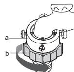
4. Raccordez le tuyau d'arrivée d'eau à l'adaptateur. Abaissez la partie (c) du tuyau d'arrivée d'eau. Lorsque vous lâchez la partie (c), le tuyau se raccorde automatiquement à l'adaptateur en faisant un « clic ».
