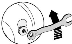
Dévissez les vis de transport situées à l'arrière de la machine à l'aide de la clé jointe.
