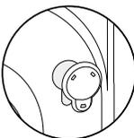
Une fois les vis retirées, obstruez les orifices avec les caches plastiques.
