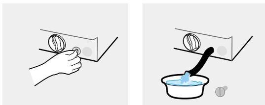
3. Placez un récipient sous le filtre, dévissez-le en tournant la poignée vers la gauche, puis tirez vers l'extérieur. Otez toute saleté ou tout corps étranger du filtre. Vérifiez que la turbine de la pompe de vidange, située derrière le filtre, n'est pas bloquée.
