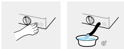
5. Réinsérez le tuyau de vidange et revissez le bouchon.
