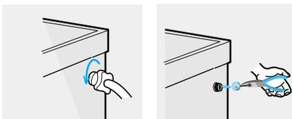
4. Nettoyez également l'intérieur et l'extérieur du raccord bleu fileté.
