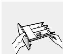
6. Réinsérez le bouchon (en le bloquant) et remplacez le séparateur de détergent liquide dans le tiroir.
