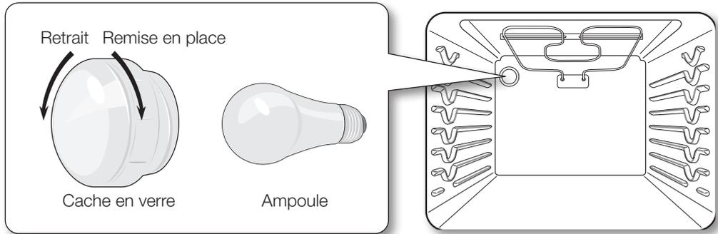
5. Remplacez l'ampoule et son cache en verre en les tournant dans le sens des aiguilles d'une montre.
