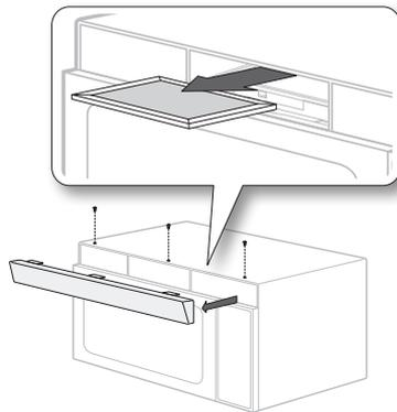
6. Placez un filtre à charbon actif neuf en le faisant coulisser. Le filtre doit être installé selon l'angle indiqué sur la figure.
