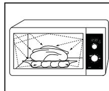
1. Les micro-ondes générées par le magnétron sont réparties de façon homogène à l'aide du plateau tournant. De cette manière, les aliments cuisent uniformément.
