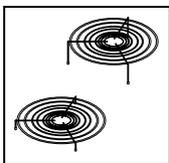
4. **Grilles** (grille du haut, grille du bas), doivent être placées sur le plateau tournant.
