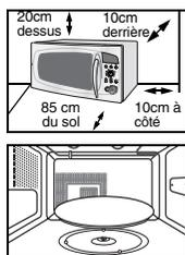
1. Placez le four sur une surface plate et horizontale qui est assez forte pour porter le poids du four. Assurez-vous que la ventilation est suffisante en laissant 10 cm d'espace au minimum derrière le four et à côté du four, 20 cm au minimum au-dessus du four et 85 cm du sol.
