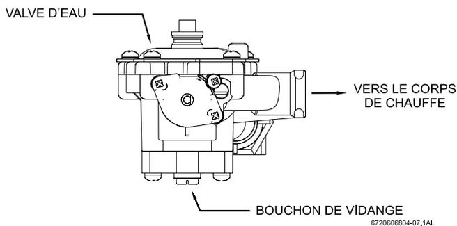
Fig. 1 - Bouchon de vidange du chauffe-eau
