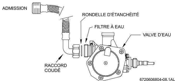
Fig. 6 - Valve d'eau (vue d'en haut)
