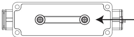
4. Tout en retenant le support en place avec une main, serrez les vis à l'aide du bon tournevis. Assurez-vous que le support est fermement attaché au boîtier du disque dur.
