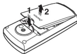
**Remarque** La batterie doit être solidement remise en place. Si elle n'est pas correctement installée, votre téléphone mobile ne se met pas sous tension et la batterie risque de tomber en cours d'utilisation.
