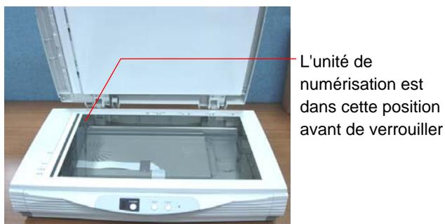
Si vous devez transporter la machine, mettez le commutateur de verrouillage sur la position "Verrouillé". Avant cela, vérifiez que l'unité de numérisation est sur le côté droit de la plaque en verre comme indiqué. (Dans le cas contraire, allumez la machine. Quand l'unité de numérisation arrive à l'extrémité droite, éteignez la machine.)
