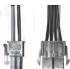
切替用導線 EPS8ピンコネクタを経由で接続するATX4ピンコネクタ
