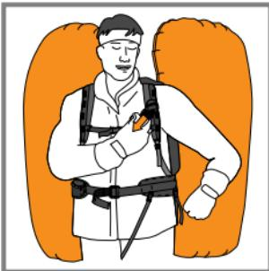
Le degré de remplissage des airbags peut varier légèrement selon la température extérieure et l'altitude. Cependant, il ne doit pas y avoir de perte de volume perceptible dans les premières minutes.
