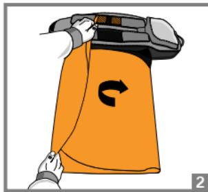
1. Legen Sie die Airbags mit der Füll- und Ablasseinheit nach unten auf den Boden. Die glatte Airbagseite zeigt nach oben.
