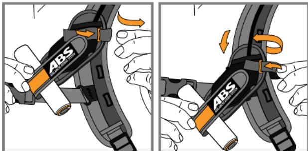
Zur Höhenverstellung Klettverschluss öffnen und ausfädeln, Griffplatte auf die entsprechende Kunststofföse aufstecken, Klettverschluss wieder einfädeln und schließen.
