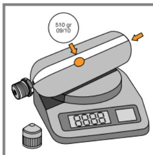
Eine vollständig gefüllte Patrone ist absolut Voraussetzung für das Funktionieren des ABS-Lawinenairbags.
