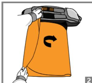
3. Repliez ensuite la partie inférieure de l'airbag. La largeur de l'airbag doit être égale à celle de la poche airbag.
