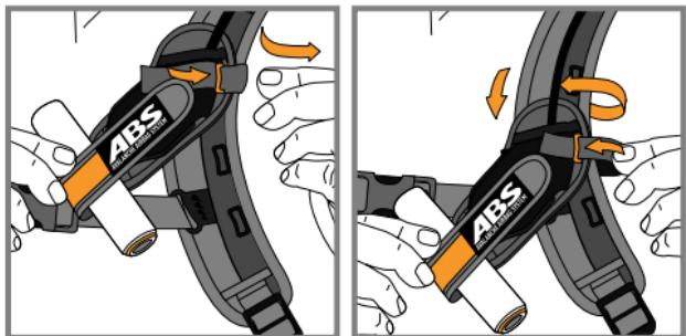
Per regolarla aprire la cerniera e sfilarla, inserire la maniglia nell'apposito occhiello di plastica, reinfiltrare il nastro e chiudere.
