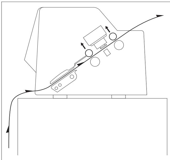
En cas de mouvements d'avance et recul fréquents avec du papier en continu, l'imprimante doit être placée comme illustré à la figure ci-contre.
