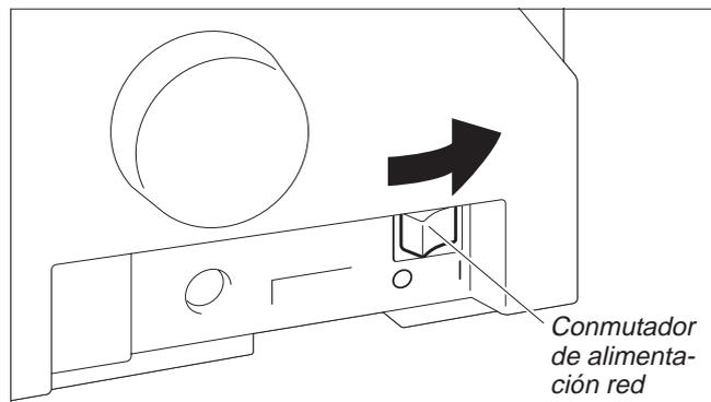
El conmutador de alimentación, con el que se enciende y apaga la impresora, se encuentra a la derecha del equipo en el lado trasero.
