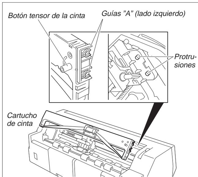
Deslice las dos guías "A", provistas a la izquierda del cartucho de cinta, por las protusiones en la impresora e inserte el cartucho; presione el cartucho hacia abajo con cuidado hasta que se engatille. Si se puede sentir resistencia, gire el botón tensor de la cinta.
