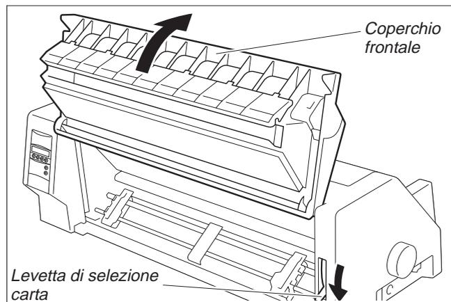
Impostare la levetta di selezione spessore carta in funzione della grammatura della carta utilizzata. Per ulteriori dettagli, vedere pagina 18, *Impostazione della distanza della testina di stampa*. Impostare la levetta di selezione carta nel modo moduli continui.
