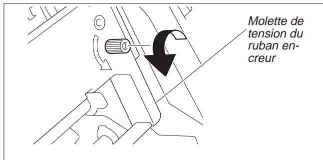
Tourner la molette de tension du ruban encreur dans le sens de la flèche pour éliminer le mou du ruban.
