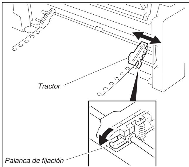
Coloque el papel en el tractor izquierdo con la cara a imprimir hacia arriba. Para ello, posicione los agujeros de transporte del borde izquierdo del papel sobre los pernos del tractor y cierre la abrazadera.
