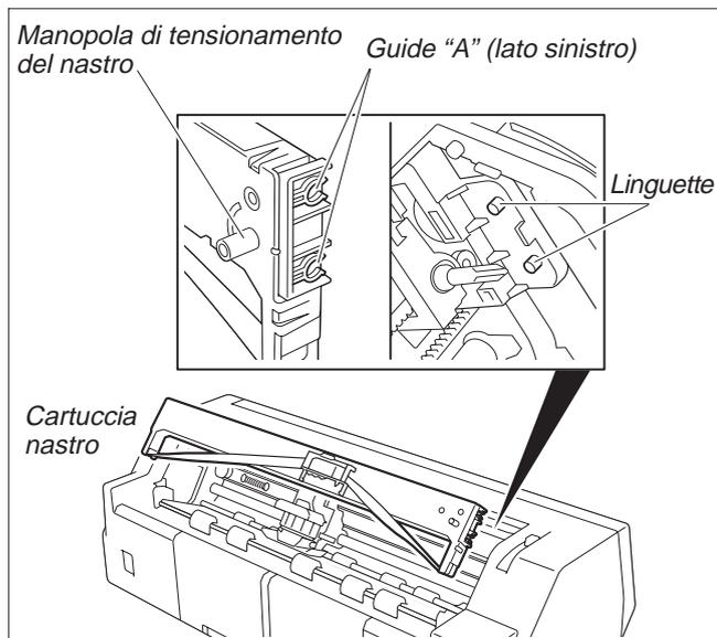
Fare scorrere le due guide “A” sul lato sinistro della cartuccia nastro oltre le linguette presenti sulla stampante e inserire la cartuccia. Spingerla con cura fino a che non si innesta. Se si avverte resistenza, ruotare la manopola di tensionamento del nastro mentre si esercita pressione.
