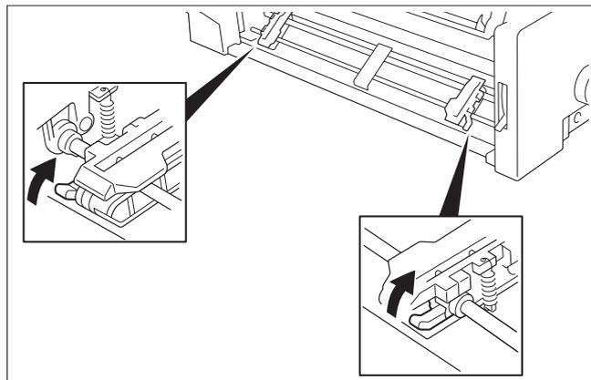
Levante las palancas de fijación izquierda y derecha hacia arriba en el sentido de la flecha para desbloquear los tractores.
