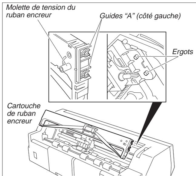
Poussez les deux guides “A” sur le côté gauche de la cartouche de ruban encreur sur les ergots de l’imprimante et introduisez la cartouche; appuyez avec précautions sur la cartouche jusqu’à ce qu’elle s’encrante. Si vous percevez une résistance, tournez la molette de tension du ruban encreur pendant que vous poussez.
