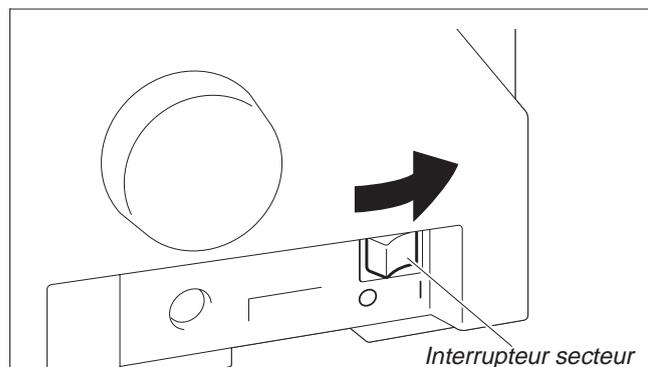
L'interrupteur principal, qui sert à la mise sous tension et hors tension de l'imprimante, se trouve à droite de l'imprimante, à l'arrière.
