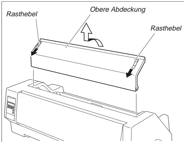
Die Rasthebel der oberen Abdeckung, die auf der rechten und linken Seite angebracht sind, in Richtung Druckervorderseite ziehen und die Abdeckung abnehmen.
