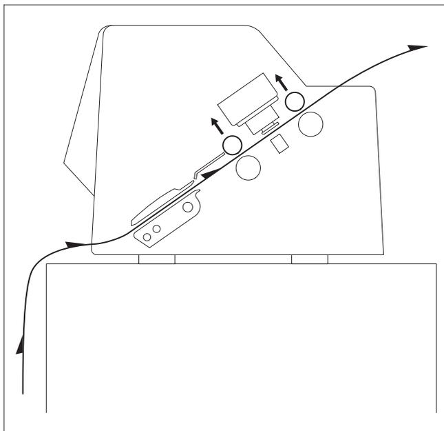
Se si prevede di utilizzare spesso i comandi di avanzamento e retrocessione della carta a moduli continui, posizionare la stampante come mostrato nella figura.
