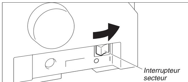
Mettez l'imprimante sous tension (interrupteur secteur sur "I"). Réglez le levier d'épaisseur du papier selon l'épaisseur du papier utilisé. Pour plus de détails à ce propos, voir la page 18 (*Réglage de l'écart de la tête d'impression*).
