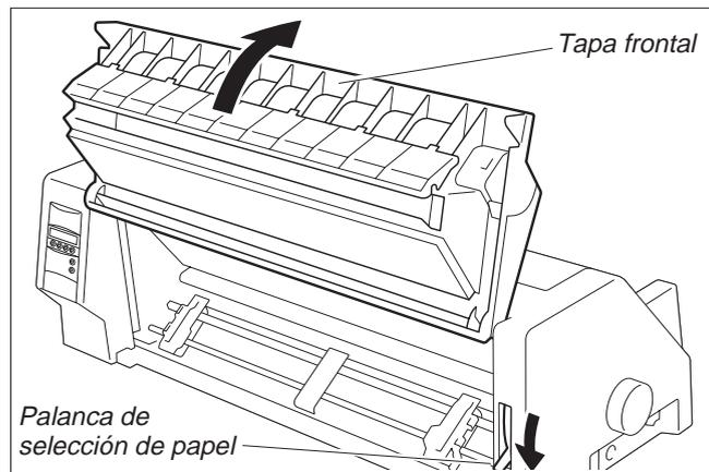
Ajuste la palanca de espesor de papel al espesor del papel utilizado. Para más detalles, véase página 18 (*Ajustar la distancia de cabeza*).
