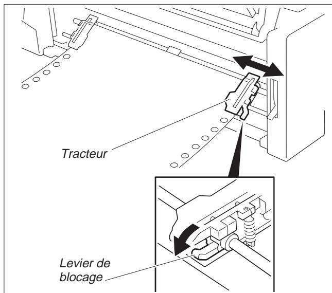
Chargez le papier avec le côté à imprimer vers le haut sur le tracteur de gauche. Pour ce faire, placez les trous de transport de la bordure de gauche du papier sur les ergots du tracteur et fermez ensuite le volet.
