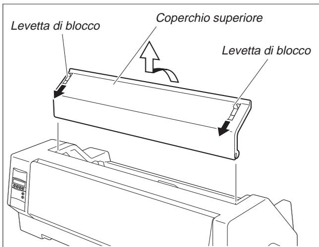
Tirare le levette di blocco del coperchio superiore, sui lati sinistro e destro, in direzione del lato anteriore della stampante e rimuovere il coperchio.
