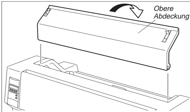
Nachdem das Einsetzen der Farbbandkassette abgeschlossen ist, die obere Abdeckung wieder anbringen.
