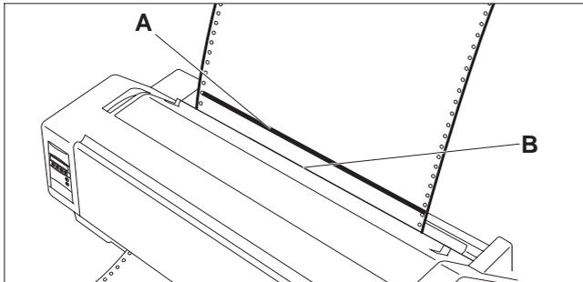
Das Papier wird so weit vortransportiert, bis die Unterkante der ersten Druckzeile **A** auf Höhe der Abreißkante **B** liegt. Werkseitig ist die erste Druckposition auf 12/72" eingestellt.
