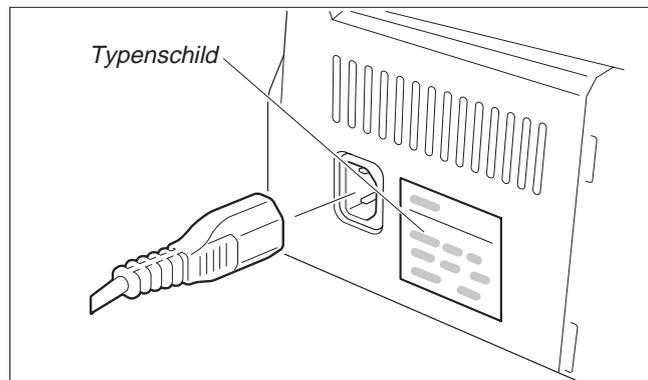
Stellen Sie sicher, daß das Gerät auf die richtige Spannung eingestellt ist (z.B. 230 V in Europa, 120 V in den USA). Siehe dazu das Typenschild neben dem Netzanschluß auf der Rückseite des Druckers.
