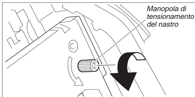
Ruotare, in direzione della freccia, la manopola di tensionamento del nastro per eliminare l'eventuale lasco.
