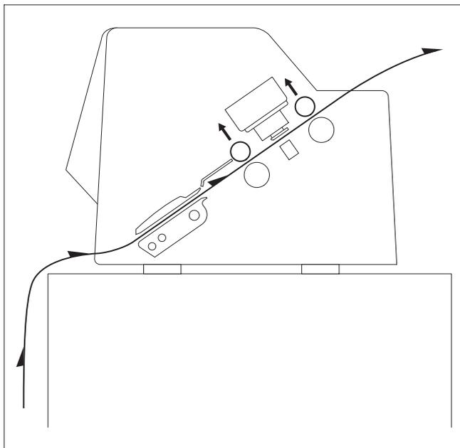
Si el papel continuo se arrastra con frecuencia hacia delante y atrás, intente colocar la impresora según se muestra en la figura. En cuanto a la ubicación de la impresora, preste también atención en los siguientes puntos:
