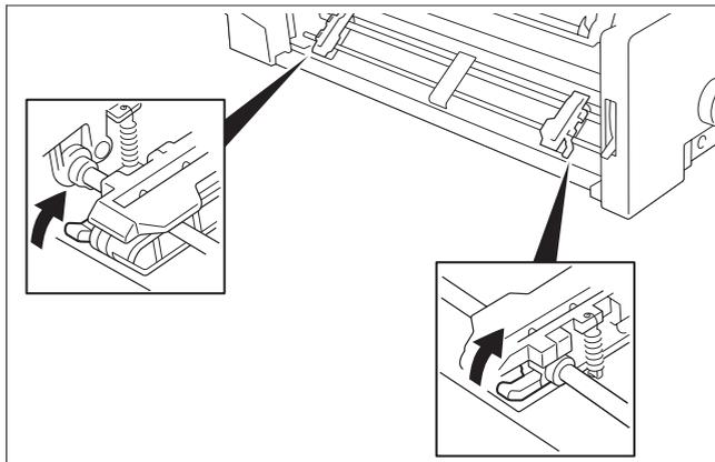
Den linken und rechten Arretierhebel in Pfeilrichtung nach oben bewegen, um die Traktoren zu entriegeln.
