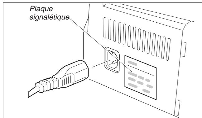
S'assurer que l'imprimante est réglée à la tension appropriée (p. ex. 230 V pour l'Europe, 110 V pour les USA). Voir la plaque signalétique près de la prise d'alimentation à l'arrière de l'imprimante.
