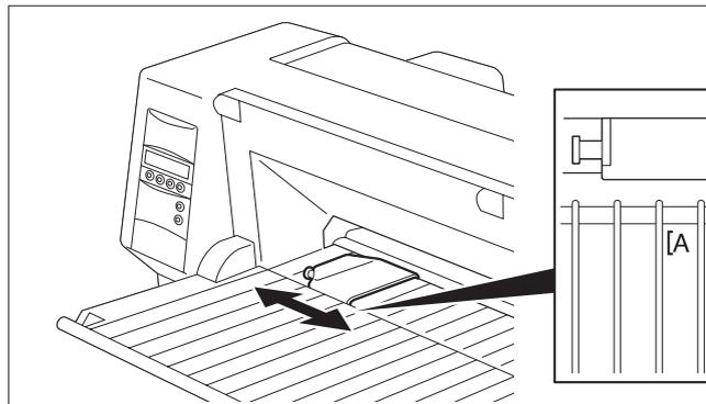
Richten Sie den linken Randsteller auf die gewünschte Position des Druckbeginns aus. (Die Marke „[A“ zeigt die Standardposition des Druckbeginns an.)
