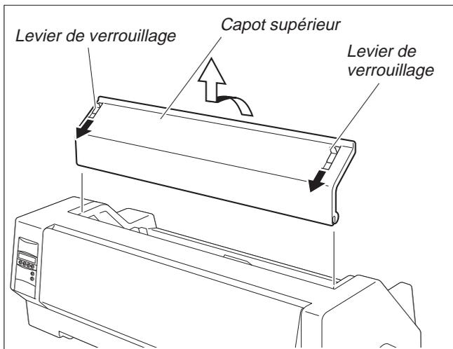
Tirer les leviers de verrouillage du capot supérieur se trouvant du côté gauche et du côté droit vers l'avant de l'imprimante et enlever le capot.
