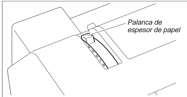
Para obtener una calidad óptima de impresión, hay que ajustar la distancia entre la cabeza de impresión y el contrasoposte de acuerdo con el espesor del papel utilizado.
