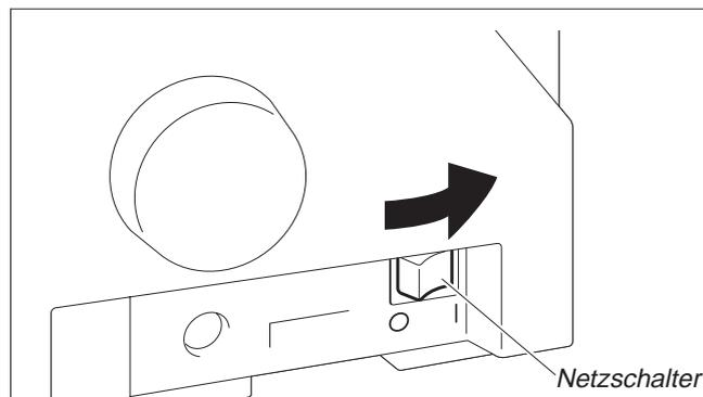
Der Netzschalter, mit dem der Drucker ein- und ausgeschaltet wird, befindet sich an der rechten Geräteseite, hinten.
