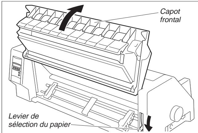
Réglez le levier d'épaisseur du papier selon l'épaisseur du papier utilisé. Pour plus de détails à ce propos, voir la page 18 (*Réglage de l'écart de la tête d'impression*).
