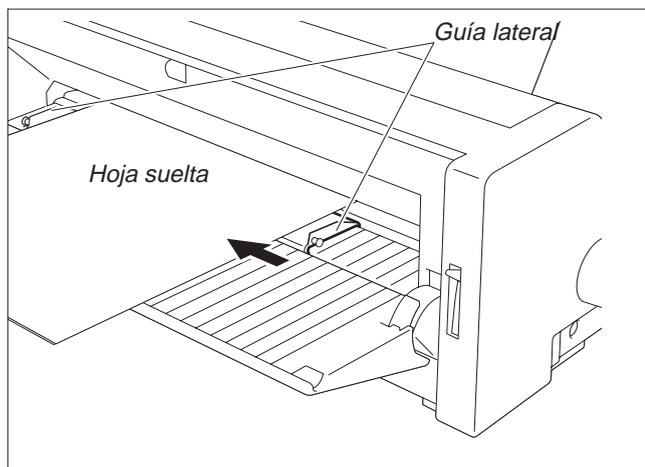
Alinee una hoja suelta con la guía lateral izquierda y ajuste la guía lateral derecha a la anchura del papel utilizado.
