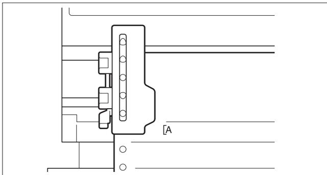
Nach Einlegen des Papiers kann mit dem linken Randsteller die gewünschte Position des Druckbeginns gewählt werden. Die Marke „[A“ zeigt die Standardposition des Druckbeginns an.
