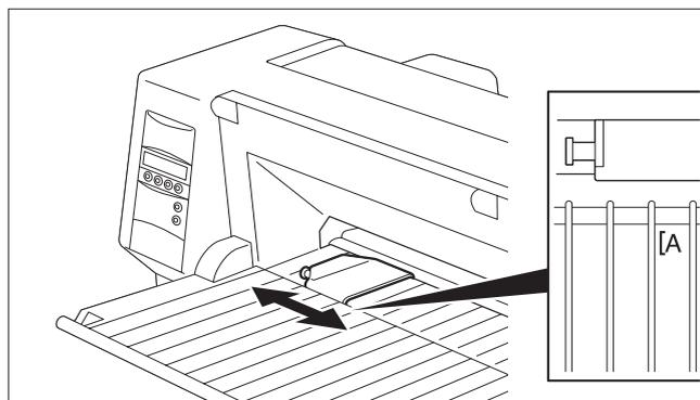
Ajuste la guía lateral izquierda para alinearla a la posición inicial de impresión deseada. (La marca "[A]" indica la posición inicial de impresión estándar.)
