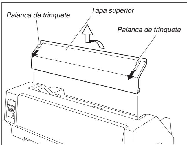
Tire las palancas de trinquete de la tapa superior, a la derecha e izquierda de la impresora, hacia el frente y quite la tapa.
