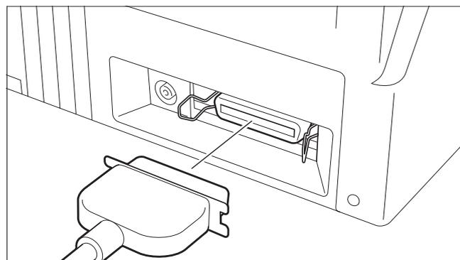
Collegare il connettore del cavo di trasmissione dei dati (lato stampante) al connettore di interfaccia femmina e fissarlo con le apposite clip a molla.
