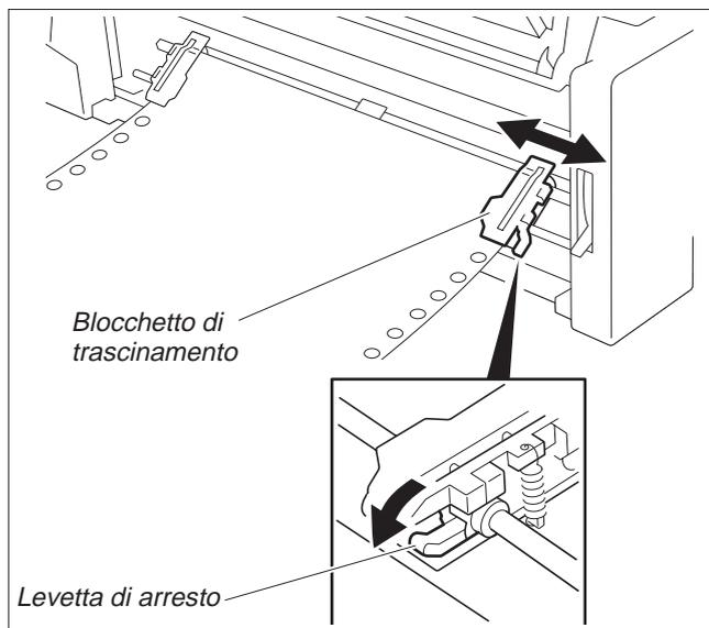
Con il lato di stampa rivolto verso l'alto, inserire la carta nel blocchetto di trascinamento sinistro facendo coincidere i fori di trascinamento sul bordo sinistro della carta con i perni del blocchetto di trascinamento, quindi chiudere il pressacarta. Fare coincidere i fori di trascinamento sul bordo destro della carta con i perni del blocchetto di trascinamento destro e chiudere il pressacarta.
