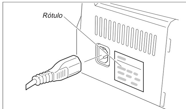
Asegúrese de que el equipo ha sido ajustado para la tensión correcta de la red (p. ej. 230 V en Europa, 120 V en los EE. UU.). Véase el rótulo al lado del enchufe de alimentación eléctrica en la parte trasera de la impresora.
