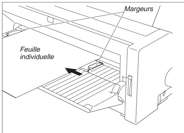
Positionnez une feuille individuelle sur le margeur de gauche et réglez le margeur de droite selon la largeur du papier utilisé. Insérez la feuille entre les deux margeurs. L'imprimante la tire automatiquement jusqu'à la position d'impression et est ensuite prête pour l'impression.
