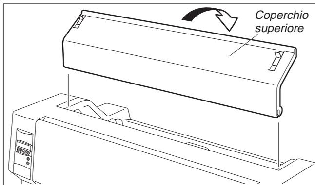
Una volta terminato il caricamento della cartuccia nastro, riapplicare il coperchio superiore.
