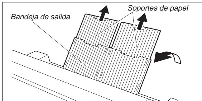
Abra la bandeja de salida levantándola en el sentido de la flecha. Detenga la bandeja de salida y retire los soportes de papel.
