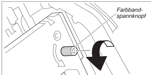
Den Farbbandspannkopf in Pfeilrichtung drehen, um jede Lose aus dem Farbband zu entfernen.
