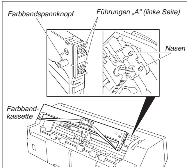
Schieben Sie die beiden Führungen „A“ auf der linken Seite der Farbbandkassette über die Nasen am Drucker und legen Sie die Kassette ein; drücken Sie vorsichtig auf die Kassette bis sie einrastet. Verspüren Sie dabei Widerstand, während des Drückens den Farbbandspannkopf drehen.
