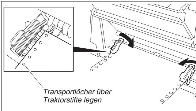
Das Papier mit der zu bedruckenden Seite nach oben in den linken Traktor einlegen. Dazu die Transportlöcher am linken Rand des Papiers über die Stifte auf dem Traktor legen und anschließend die Traktorklappe schließen.
