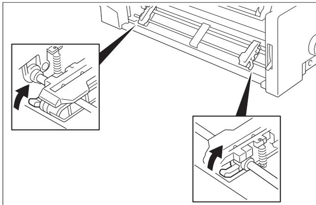
Déplacez les leviers de blocage de gauche et de droite vers le haut dans le sens de la flèche pour déverrouiller les tracteurs.
