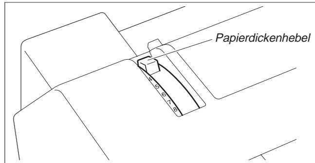
Um eine optimale Druckqualität zu erzielen, muß der Abstand zwischen Druckkopf und Gegenlager entsprechend der Dicke des verwendeten Papiers eingestellt werden.
