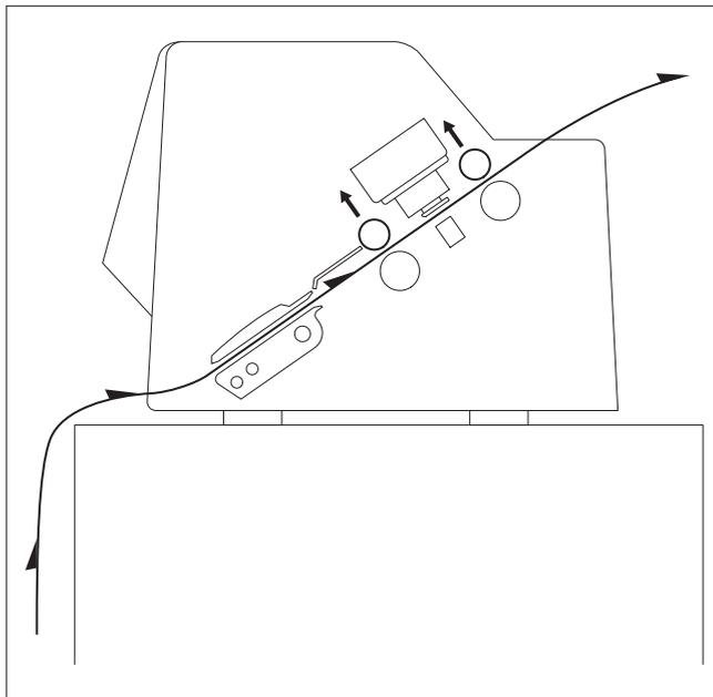
Wird Endlospapier häufig vor- und zurücktransportiert, den Drucker möglichst so aufstellen, wie im Bild dargestellt.
