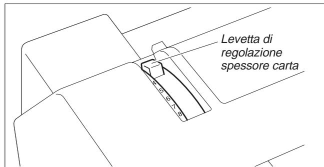
Per ottenere la massima qualità di stampa, occorre regolare la distanza tra la testina e il supporto esterno in funzione dello spessore (grammatura) della carta utilizzata.
