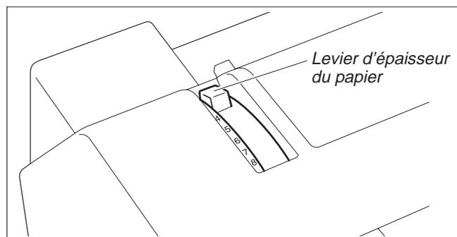
Pour obtenir une qualité d'impression optimale, l'écart entre la tête d'impression et le contre-appui doit être réglé selon l'épaisseur du papier utilisé.
