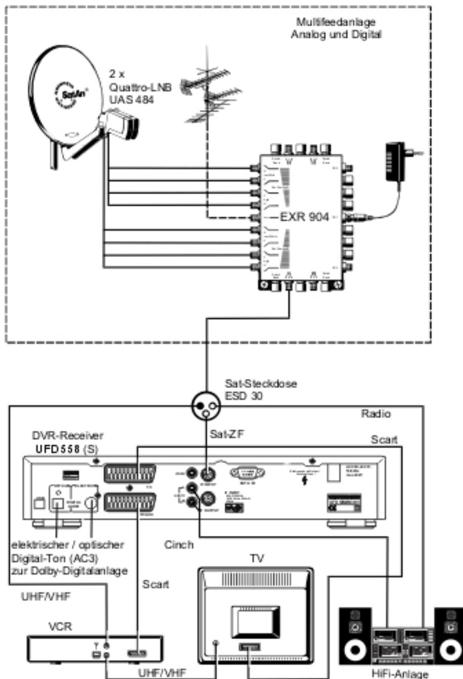
Raccordement du récepteur sat. DVR à un téléviseur (TV), à un magnétoscope (VCR) et une chaîne hi-fi pour la réception et l'enregistrement de chaînes satellite TV et radio.
