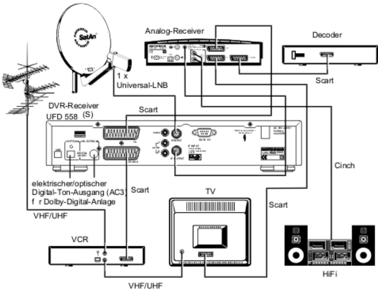
Connexions d'un récepteur sat. DVR avec un récepteur Sat analogique et avec une installation complète de télévision et une chaîne hi-fi. La sortie audio numérique peut être reliée à une installation Dolby numérique.
