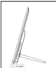
Соедините приложенный **блок питания** с цифровой фоторамкой (**DC-IN**). Вставьте другой конец блока питания в **розетку**. **цифровой фоторамки** включается автоматически. Держите кнопку включения **Power** на протяжении короткого времени нажатой, чтобы выключить или повторно включить ее.
