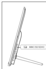
Вставьте **карту памяти** в гнездо устройства считывания с карты, при этом **логотип должен быть направлен в сторону, противоположную экрану**.
