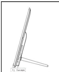
Connectez l'**adaptateur secteur** fourni à l'écran photo (**DC-IN**). Branchez l'autre extrémité de l'**adaptateur** dans la **prise**. L'écran photo démarre alors automatiquement. Maintenez la touche **power** brièvement enfoncée pour désactiver ou réactiver l'appareil.
