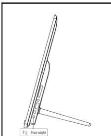
Połącz dostarczony **zasilacz** z ramką (**DC-IN**). Podłącz drugą wtyczkę **zasilacza** do **gniazdka sieciowego**. Ramka uruchomi się automatycznie. Wciśnij krótko przycisk **Power**, aby wyłączyć lub ponownie włączyć.
