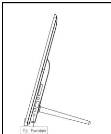
Conecte o transformador anexado com a moldura digital (**DC-IN**). Coloque a outra extremidade do **transformador na tomada**. A moldura digital inicia automaticamente. Mantenha a tecla **Power** pressionada por um curto espaço de tempo para a desligar ou voltar a ligar.
