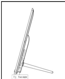
Conecte la **fuente de alimentación** suministrada al marco digital (**DC-IN**). Enchufe el extremo opuesto de la **fuente de alimentación** a la **toma de corriente**. El **marco digital** se inicia de forma automática. Mantenga pulsada brevemente la tecla **Power**, para apagarlo o volver a encenderlo.
