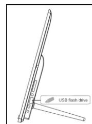
Das **USB Speichermedium** kann nur in einer Richtung in den USB Slot eingesetzt werden.
