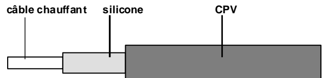
Structure du câble chauffant NH2 GMY-90
