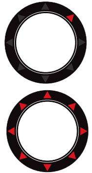
Une fois l'objet positionné dans les bagues de ciblage du chercheur, toutes les flèches directionnelles s'éclairent simultanément.
