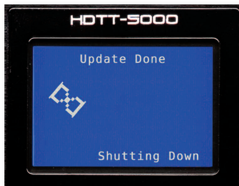
Fig 3.3 - Extinction complète de l'appareil à l'issue de l'installation de la mise à jour
