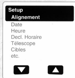
Fig. 20: Les options de menu s'affichent sur la deuxième ligne. Utilisez les touches de défilement pour vous déplacer vers le haut ou vers le bas dans la liste des options. Appuyez sur ENTER pour sélectionner l'option désirée.
