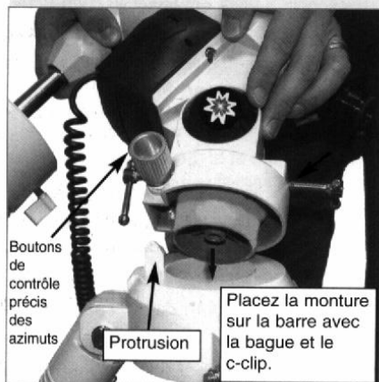
Fig. 5c: Fixez la monture sur le trépied.
