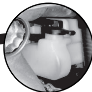
Hublot du niveau du liquide de refroidissement
