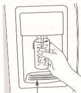
Bac de trop-plein
