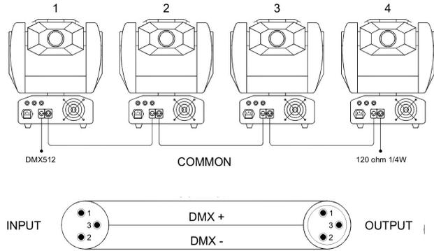
Cada efecto luminoso en la cadena necesita disponer de su propia dirección de inicio de forma que sepa qué comando del controlador debe descodificar.
