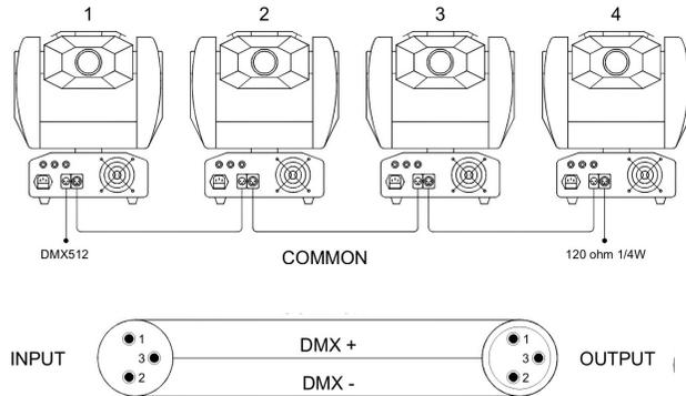
Chaque appareil dans la chaîne doit avoir sa propre adresse de départ afin de savoir quelles commandes, venant du contrôleur, il doit decoder.
