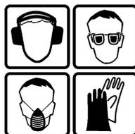
Lleve puesto el equipo de protección personal apropiado: orejeras, gafas de protección y mascarilla en trabajos que levantan polvo, y guantes de protección al trabajar con materiales rugosos y al cambiar de herramienta.
