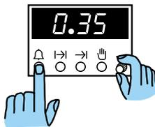
**i** **COUPURE DE COURANT** - En cas de coupure de courant, tous les réglages du programmateur sont effacés (heure courante, programmes réglés ou en cours). Lorsque le courant revient, l'afficheur signale la nécessité d'une nouvelle mise au point (chiffres clignotants).
